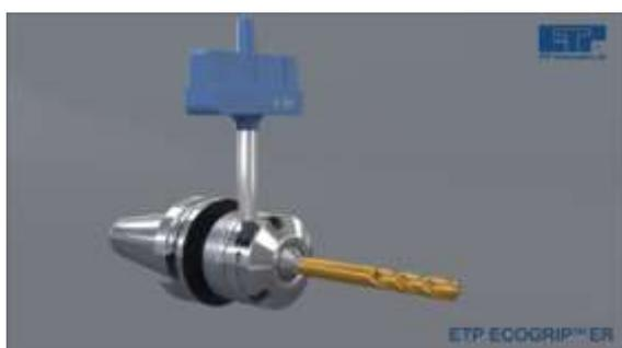
5.プレッシャースクリューを締めて工具を把持します。締め付けトルクは6Nmです。
